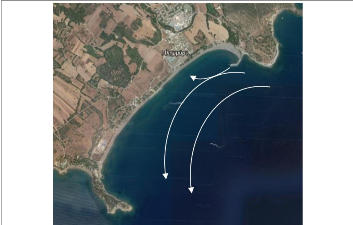
Εικόνα 2.21 Διάταξη των ρευμάτων εντός του όρμου του Πλημμυρίου.
